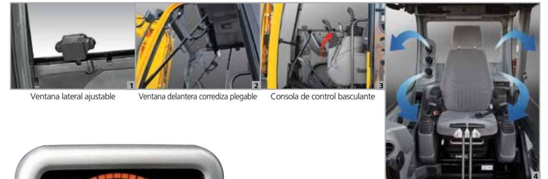
Ventana lateral ajustable    Ventana delantera corrediza plegable    Consola de control basculante
