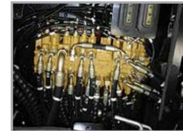
Para lograr una precisión óptima, Hyundai rediseñó el sistema hidráulico para ofrecer al operador un tacto de alta calidad y gobernabilidad mejorada. El control de flujo de la bomba mejorado reduce el flujo cuando los controles no se usan para minimizar el consumo de combustible. Las válvulas de bobina mejoradas en las válvulas de control fueron diseñadas para proveer un flujo más preciso en cada función con menos esfuerzo.
