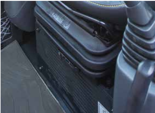
El filtro de aire está ubicado debajo de la posición del asiento para facilitar el mantenimiento.
