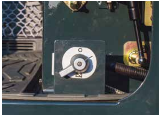
Interruptor de emergencia
