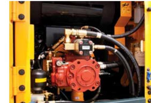
Para lograr una precisión óptima, Hyundai rediseñó el sistema hidráulico para brindarle al operador un toque súper fino y una capacidad de control mejorada. El control mejorado del flujo de la bomba reduce el flujo cuando no se usan los controles para minimizar el consumo de combustible.
