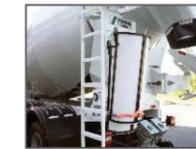
Canaletas de Descarga Fabricadas en Poliuretano
