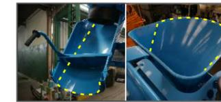
Chapas de Desgaste carga y descarga
