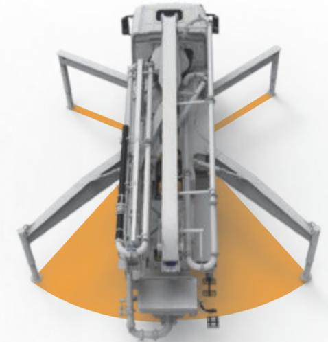
Bomba de hormigón con estabilizadores X y giratorios combinados
